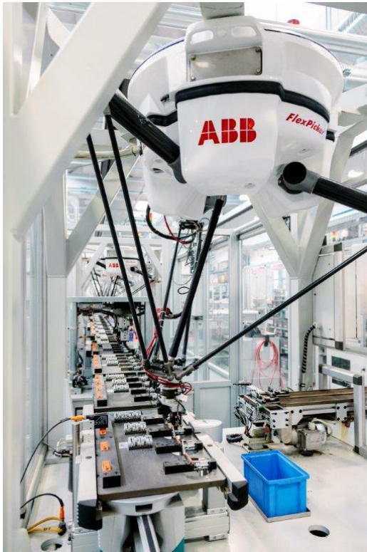
Der Flexpicker von ABB: Highspeed-Picking in der Elektronikfertigung
